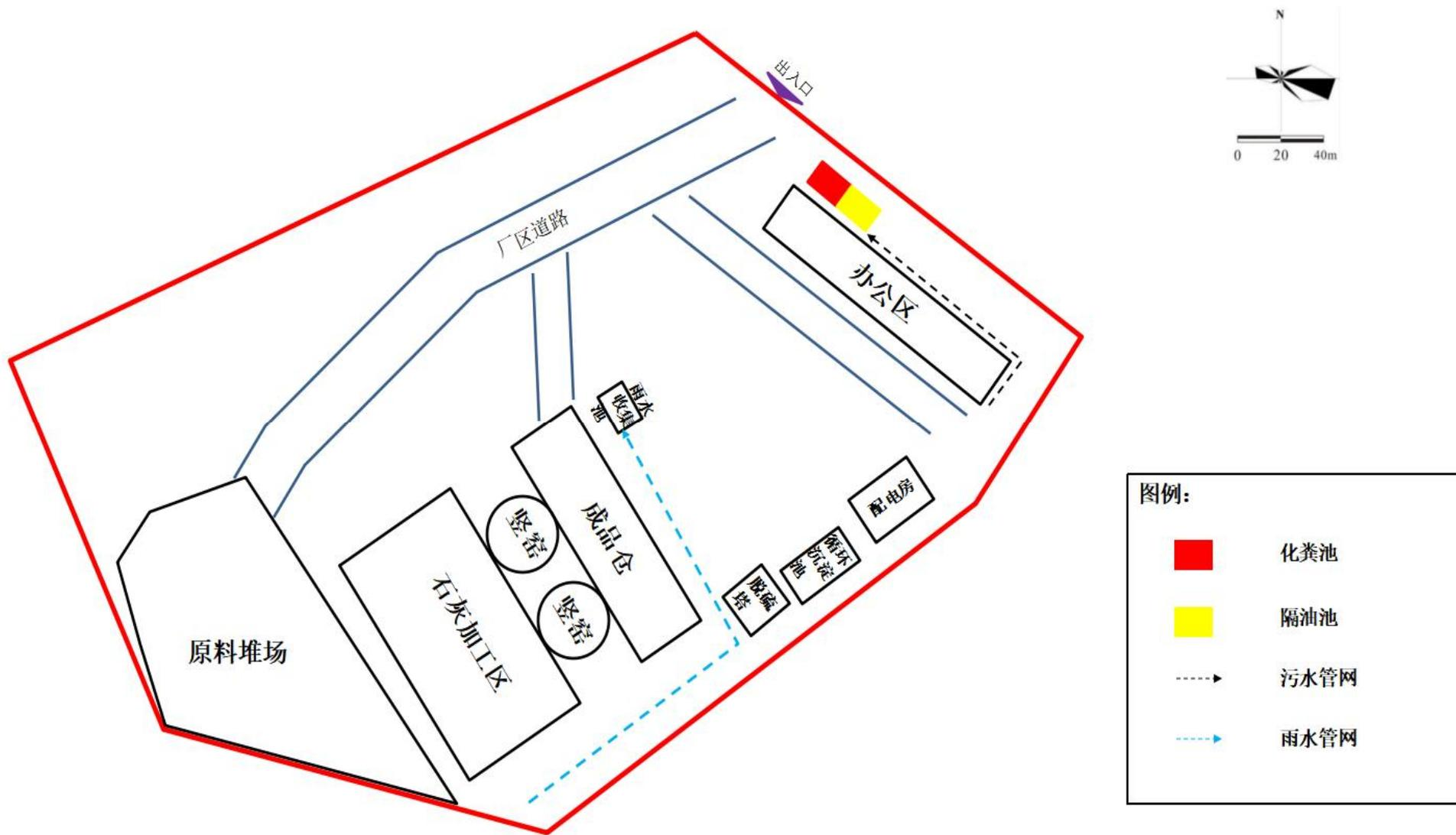
附图4 总平面布置图及雨污管网图
