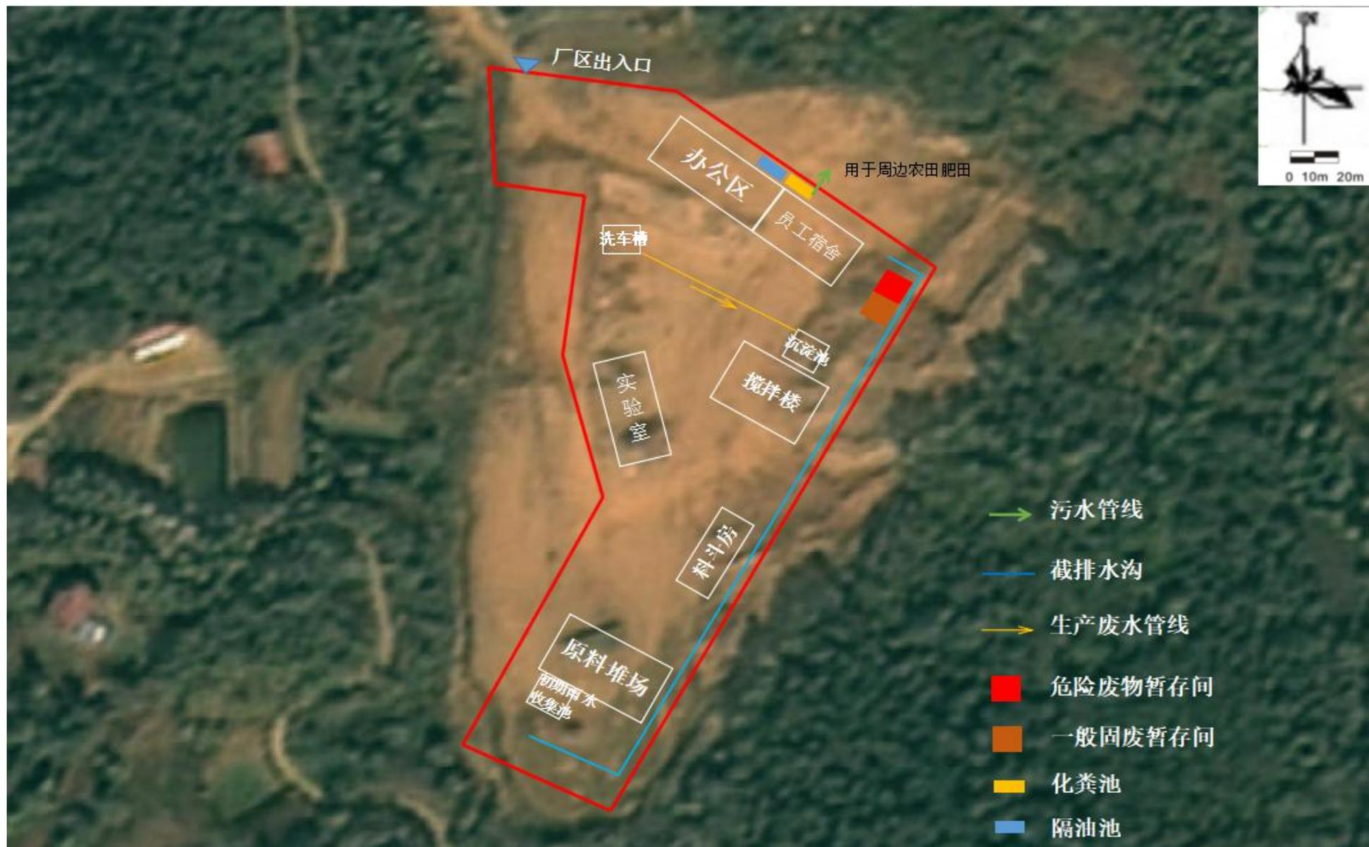
附图 4 项目总平面布置图及排水线路图
